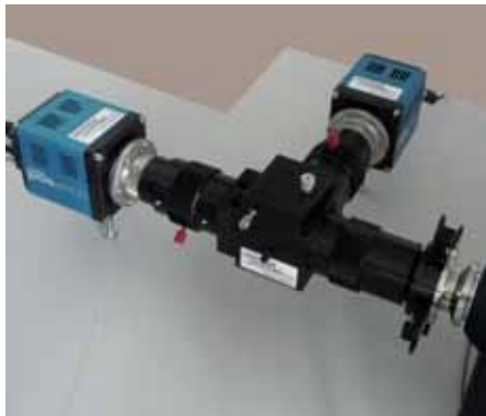
DualCam with two sCMOS edge cameras.
